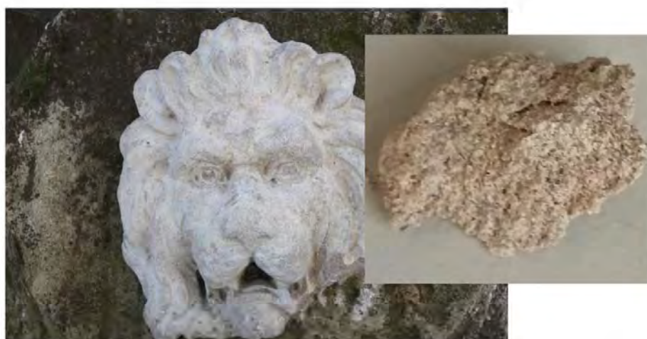
Proba P12. Probă de preparare dintr-un element heraldic profilat – Cap de leu în altorelief, care decorează axul fațadelor estică, nordică și vestică.
