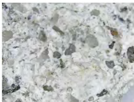
Fig.16 Proba 15 Tencuială a. micrografie OM 500X b.spectrul XRF
