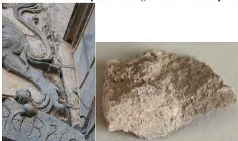
Proba P20. Fațada vestică, intrare secundară, decorație heraldică profilată - Leu cu șarpe localizată deasupra intrării, probă din preparație prelevată de pe placa suport a decorației.
