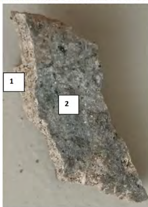
Fig.5 Straturile de materiale mozaic paviment
