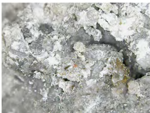
Fig.7 Proba 7 Mortar de reparație ciment a. micrografie OM 500X b.spectrul XRF;
