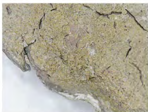
Proba P13. Fațada estică, partea sud-estică, ancadramentul cu stâlpi decorativi și adosați de la intrarea în camera P20 (la parter), probă din stratul solzit de culoare ocru- verde (la suprafața stratului) de pe stâlpul din dreapta.
