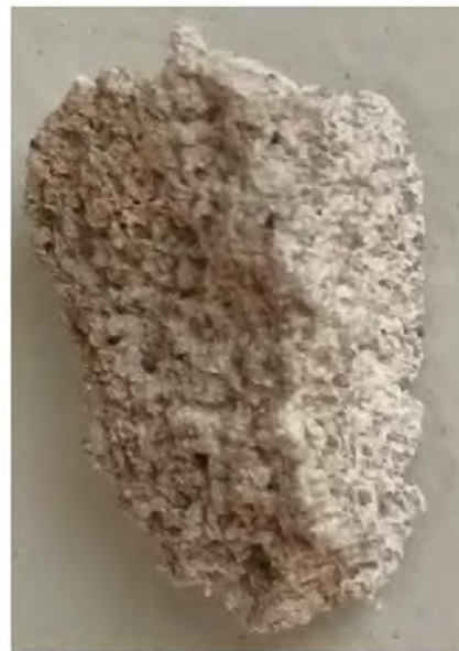
Proba 14. Fațada estică, partea sud-estică, ancadramentul cu stâlpi decorati și adosați de la intrarea în camera P20 (la parter), probă din stratul de preparație de pe stâlpul decorat din stânga.
