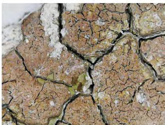
Fig.8 Proba 8 Fațadă sud,parter,fereastră SV,ancadrament A.mortar a. micrografie OM 500X b.spectrul XRF B.pigmenți c. micrografie OM 500X d.spectrul XRF
