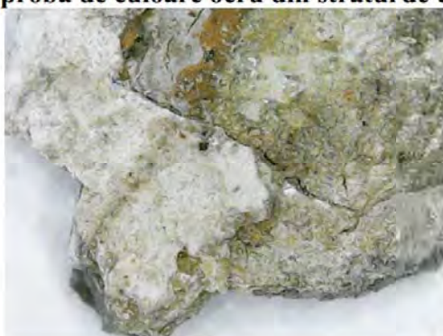
Proba P31. Fațada estică, partea nord-estică, decorație în altorelief – Leu heraldic pe scut de ceramică , probă de culoare ocru din stratul de culoare cu preparație subțire de pe scut.
