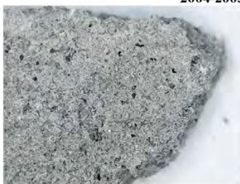
Proba P33. Fațada sud, partea sud-vestică, Stema monumentală a castelului cu patru lei susținând blazonul familiei Sturdza , probă din strat de reparație dură cu ciment existent pe aria din spatele leilor, acoperită cu culoare brun peste un strat anterior ocru (ambele probabil var lavabil din 2004-2005).
