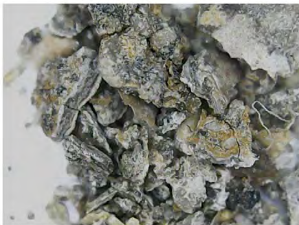
Fig.6 Proba 6 Ornament aplicat -leu perete Vest a. micrografie OM 500X b.spectrul XRF;
