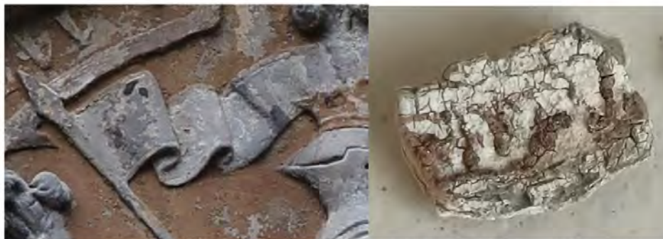
Proba P24. Fațada sud, partea centrală, decorație în altorelief - Stema sigiliu cu cavalerul Turzo , probă din stratul de culoare gri (la suprafață) de pe steagul purtat de cavaler.
