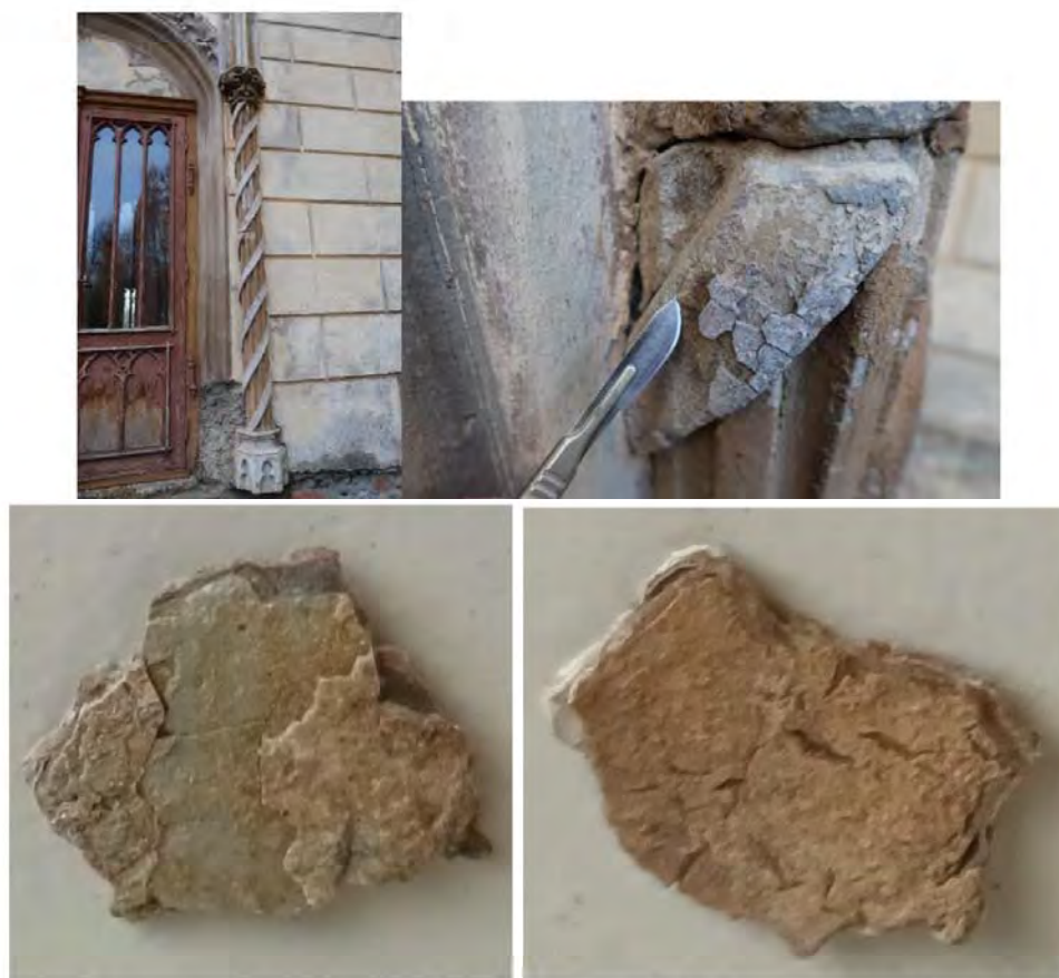
Proba P13. Fațada estică, partea sud-estică, ancadramentul cu stâlpi decorativi și adosați de la intrarea în camera P20 (la parter), probă din stratul solzit de culoare ocru- verde (la suprafața stratului) de pe stâlpul din dreapta.
