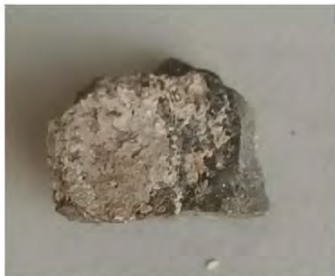
Proba P7. Fațada sud, partea sud-vestică, ancadramentul cu coloane de la intrarea A în castel, probă din mortar de reparație (ciment?) de la baza coloanei din stânga.
