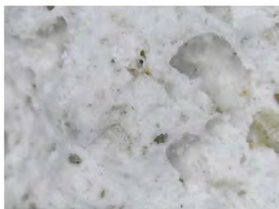
Fig.5 Proba P 5. Mortar de reparație de la baza coloanei din stânga a. micrografie OM 500X b. spectrul XRF;
