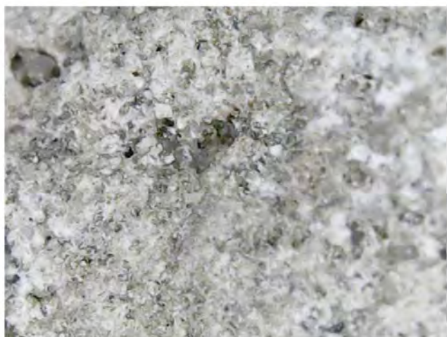
Fig.7 Proba 7 Mortar de preparare Vest a. micrografie OM 500X b.spectrul XRF;
