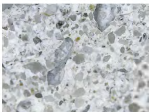
Proba P16. Fațada estică, partea sud-estică, profilul soclului castelului, probă din materialul suport cu strat de culoare ocru din 1900.
