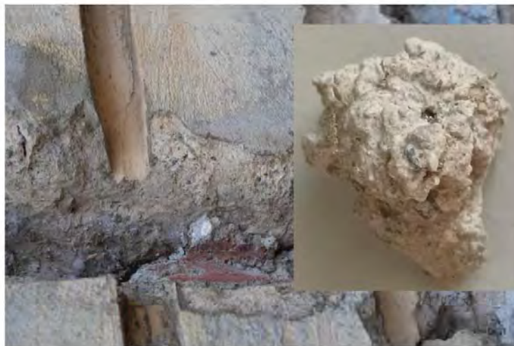
Proba 15. Fațada estică, partea sud-estică, profilul soclului castelului, probă de tencuială din 1900.
