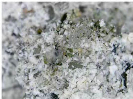
Fig.1 Proba 1.A Mortar a. micrografie OM 500X b.spectrul XRF; B Tencuială c. micrografie OM 500X b.spectrul XRF;
